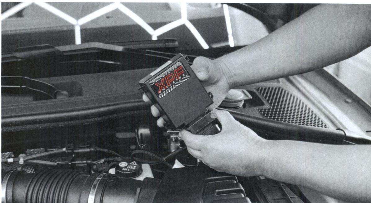
**Rimuovi il connettore di BYPASS dal cablaggio e collega la centralina XPF.**
